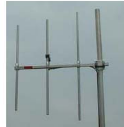
Yagi VHF de 3 elementos excitada por un dipolo simple
