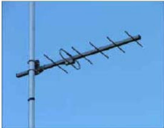
Yagi UHF excitada por un dipolo plegado con reflector simple
